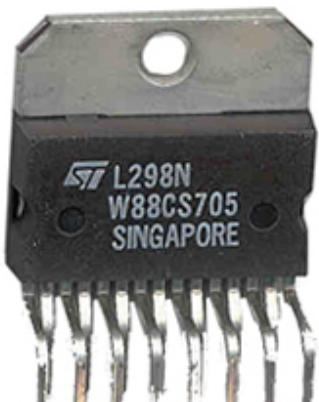
همان طور که در شکل می بینید ، یک قطعه فلز در پشت این IC تعییه شده تا با انتقال گرمای IC به محیط ، مانع گره شدن بیش از حد IC شود . این قطعه Heat sink نام دارد . گاهی برای اطمینان بیشتر از یک Heat sink کمکی نیز استفاده می کنیم ، به این صورت که Heat sink به وسیله ی پیچ به Power sink بسته می شود .
